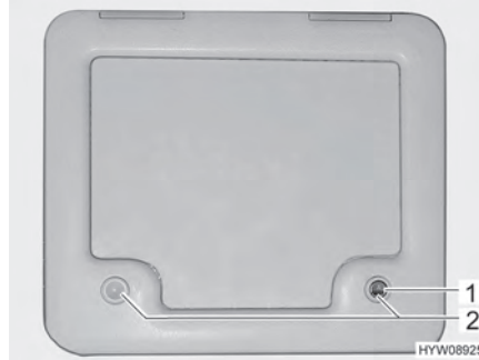
Bild 157 Lucka för latrintanken
