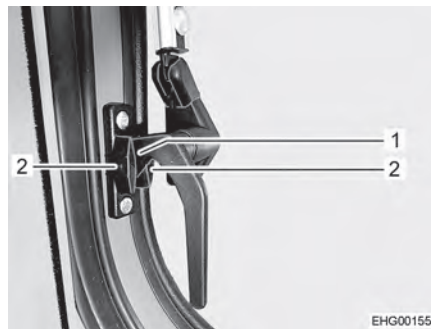
Bild 43 Låsarm, i sidan (i läget "kontinuerlig vädring")
