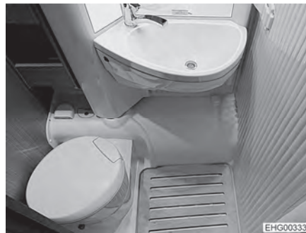
Bild 148 Toalettstol, vriden mot väggen
