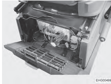
Bild 98 Monteringsställe el-block (Fiat/Citroën)
