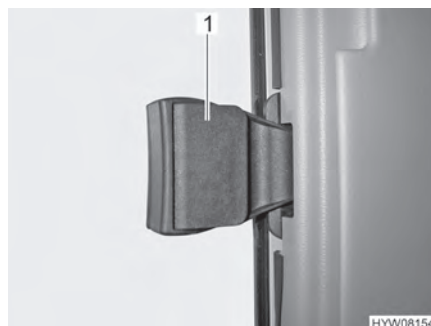
Bild 37 Skjutfönster utan lås
