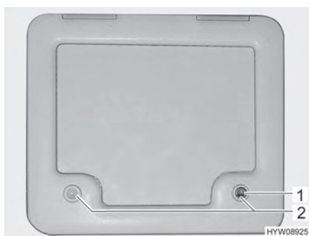
Bild 117 Lucka för latrintanken
