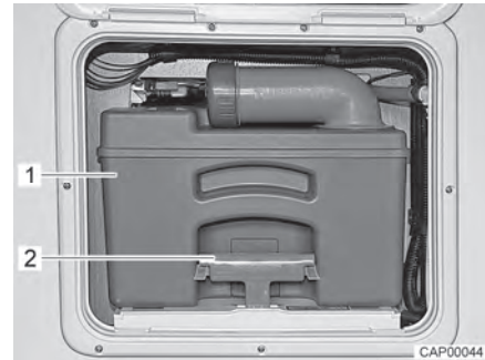
Fig. 158 Depósito de aguas fecales
