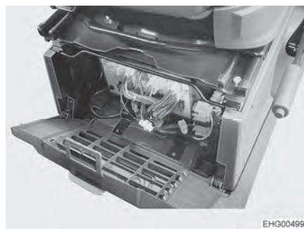
Fig. 98 Lugar de instalación del bloque eléctrico (Fiat/Citroën)
