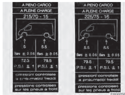
Fig. 173 Etiqueta adhesiva de información acerca de la presión de los neumáticos en la columna B (ejemplo)
