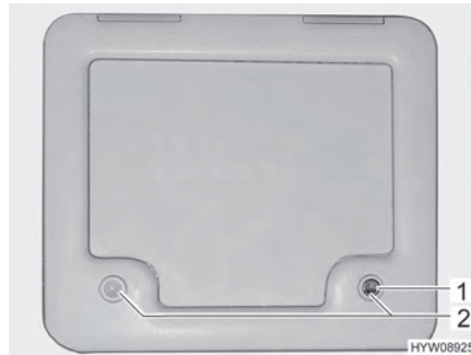
Fig. 157 Trampilla para el depósito de aguas fecales
