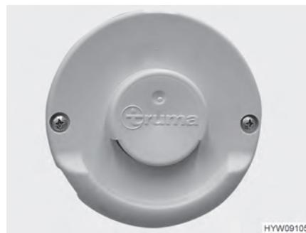
Fig. 125 Tubo de chimenea en la pared (calefacción de aire caliente)
