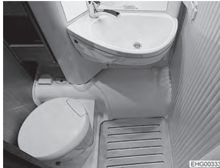
Fig. 148 Asiento del inodoro, girado hacia la pared
