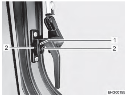
Fig. 43 Palanca de bloqueo de al lado (posición "Ventilación continua")
