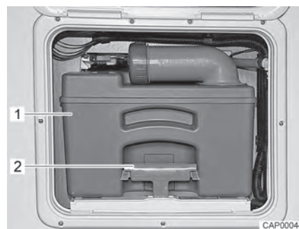
Fig. 118 Depósito de aguas fecales
