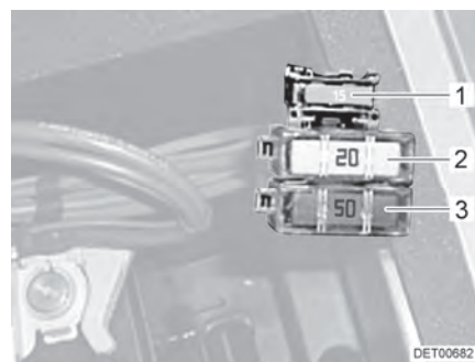
Fig. 81 Fusibles en la batería del motor de arranque sin amplificador de carga
