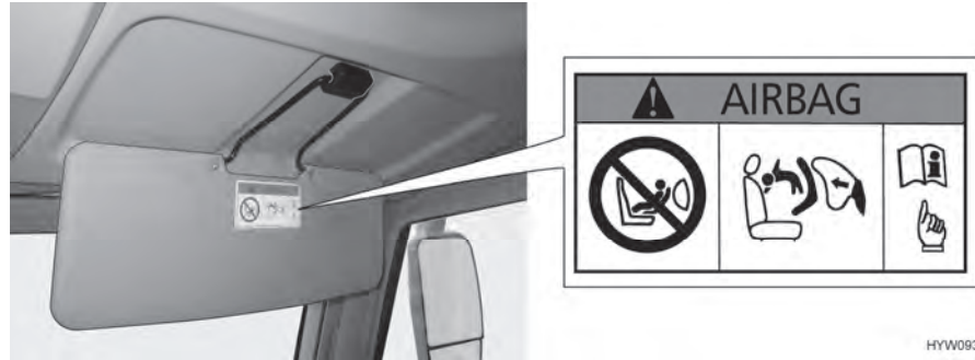
Fig. 11 Indicación de advertencia Sistema de retención infantil (parasol del asiento del acompañante)
