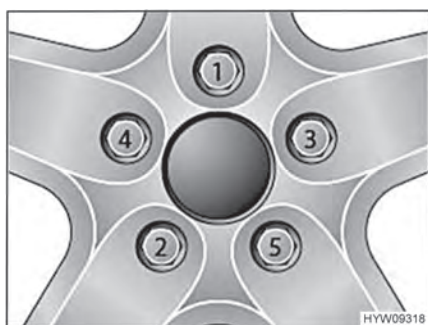
Fig. 127 Apretar las tuercas o los tornillos de las ruedas en forma de cruz
