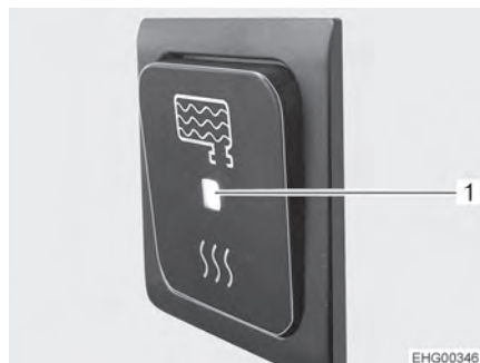
Fig. 112 Interruptor de encendido/apagado, conectado
